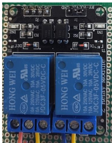
Σχήμα 3-4: Το relay module που χρησιμοποιείται για τις ανάγκες της διπλωματικής.φσ
