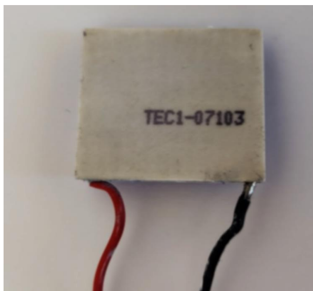
Σχήμα 3-6: Η θερμοηλεκτρικό στοιχείο που χρησιμοποιείται στην πειραματική διάταξη.
