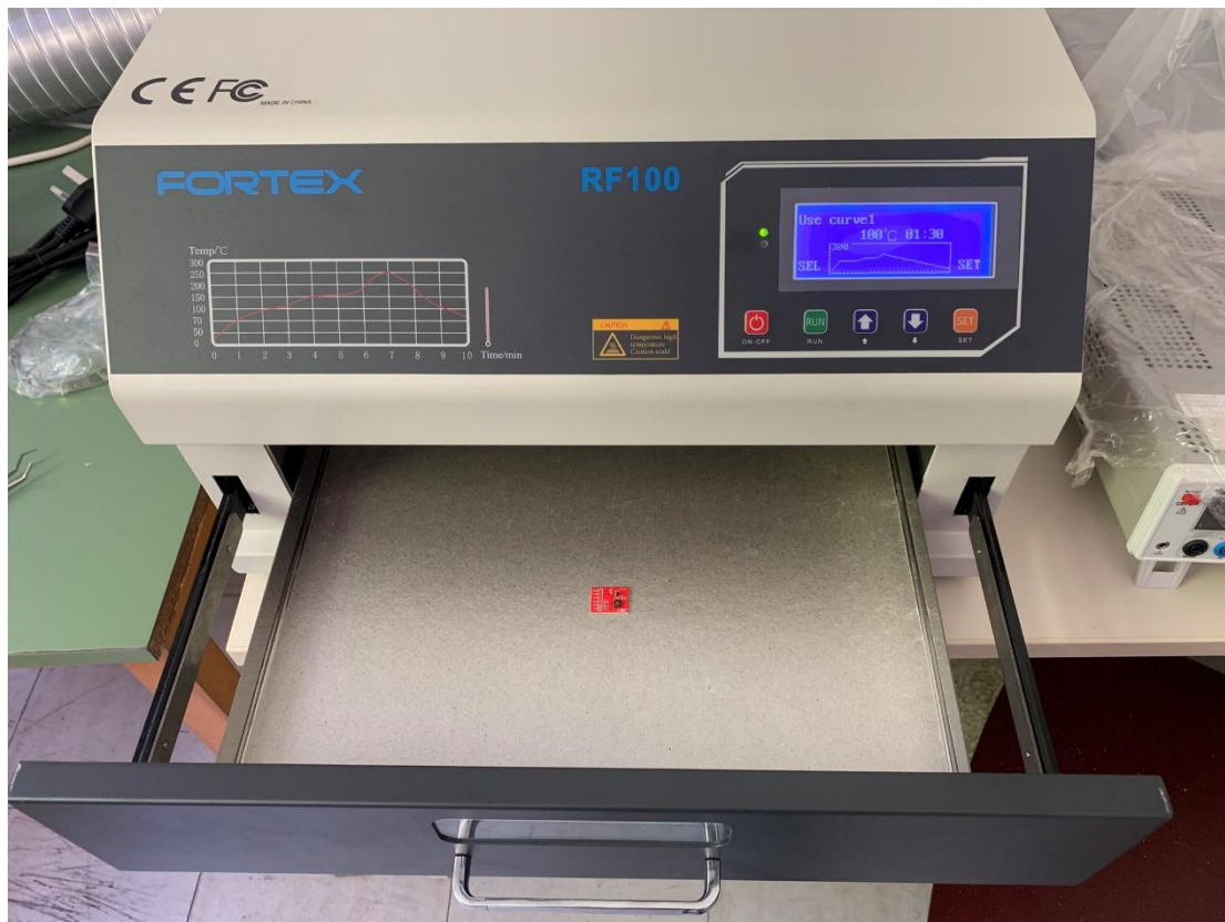
Σχήμα 4.29 - PPG Τοποθέτηση πλακέτας στον φούρνο αναθέρμανσης
