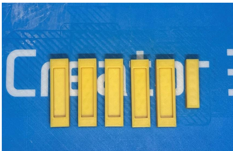
Σχήμα 5.3: (Πηγή: Φωτογραφίες συγγραφέα): Εκτύπωση δοκιμαστικών Blocks με ορθογώνια εσοχή 0.0-0.8 και κοινό insert για έλεγχο ανοχών
