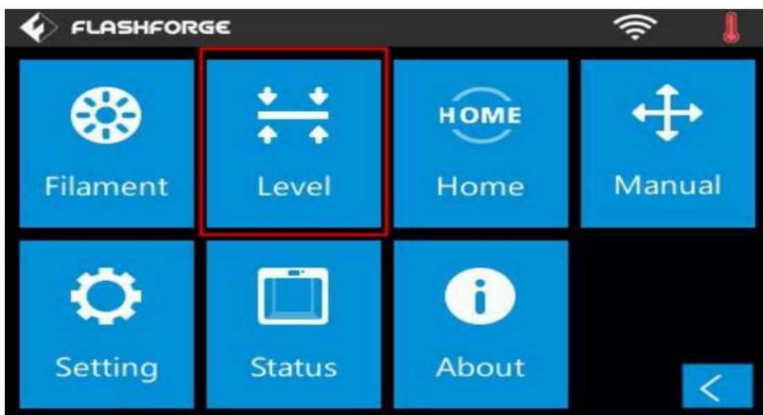
Σχήμα 3.7 (Πηγή: FlashForge manual): Η επιλογή «Level» στην οθόνη του FlashForge Creator 3[18].
