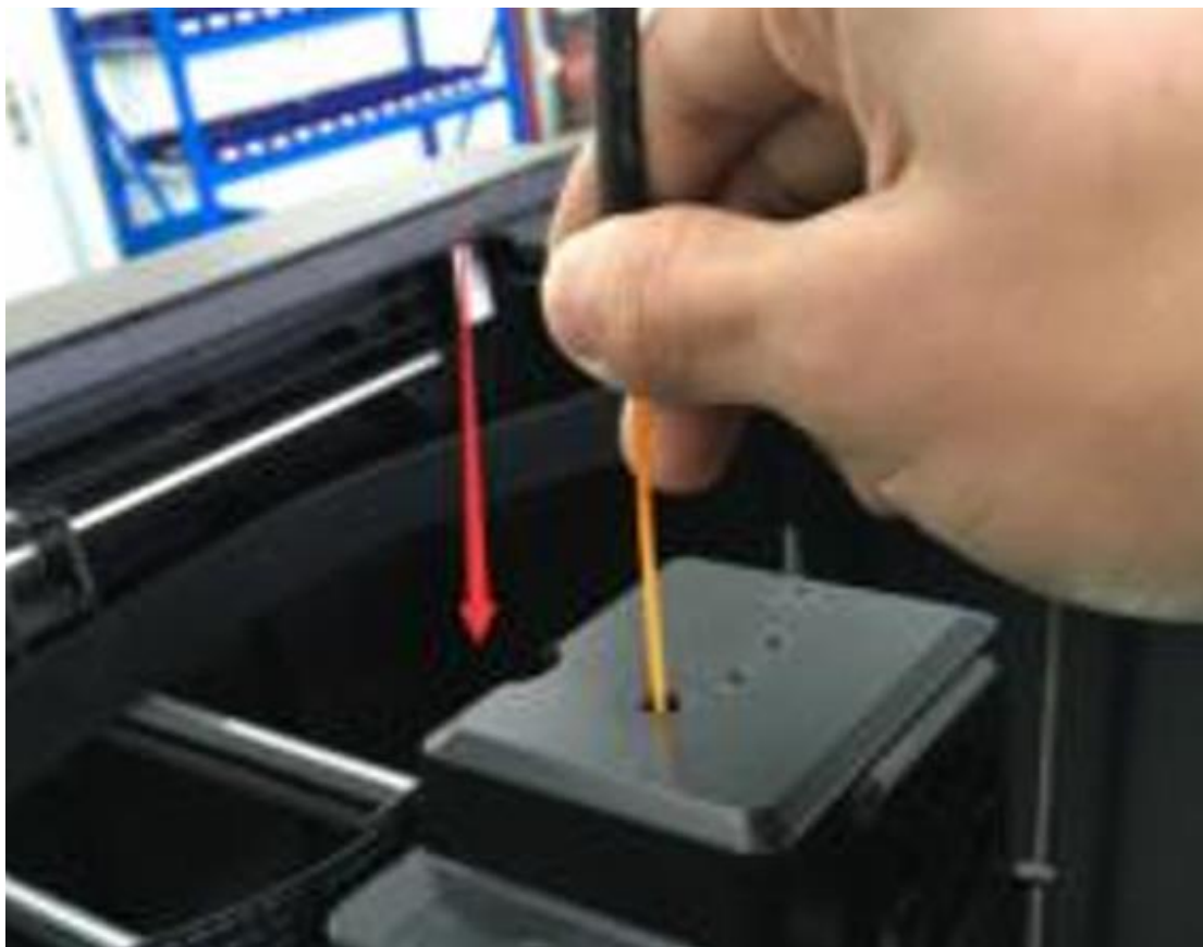
Σχήμα 3.9 (Πηγή: FlashForge manual): Τοποθέτηση υλικού στην κεφαλή με το χέρι[18].
