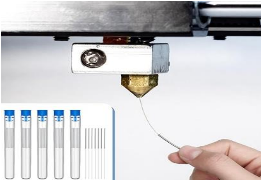
Σχήμα 3.13 (Πηγή: amazon): Το εργαλείο καθαρισμού του εξωθητή και ο τρόπος χρήσης του[28].
