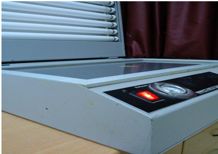
Σχήμα 1. Θάλαμος υπεριώδους έκθεσης (UV)
