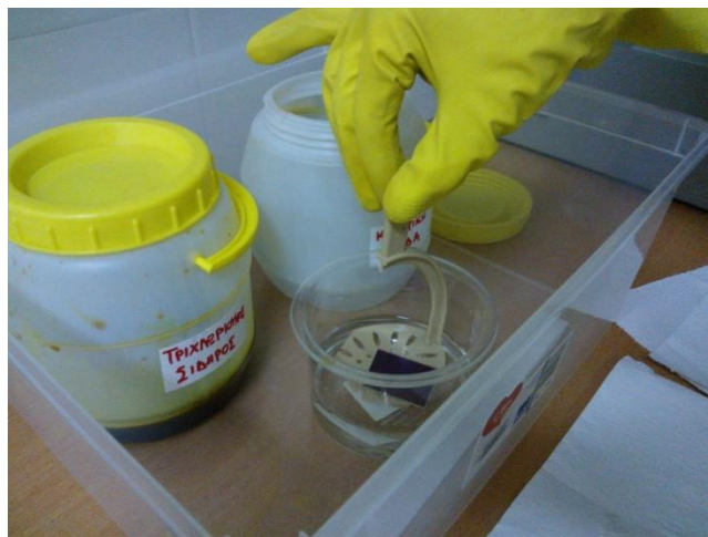
Σχήμα 12. Καθαρισμός με ασετόν
