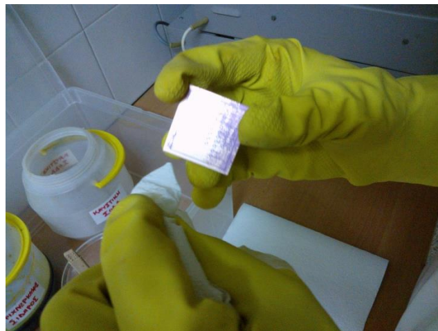
Σχήμα 13. Πλύσιμο με απιονισμένο νερό
