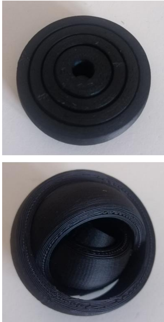
Σχήμα 6.14: Στην παραπάνω διάταξη φαίνεται πώς μπορεί να περιστραφεί ένα κυλινδρικό τμήμα μέσα σε ένα άλλο χωρίς αυτά να είναι ενωμένα μεταξύ τους.
