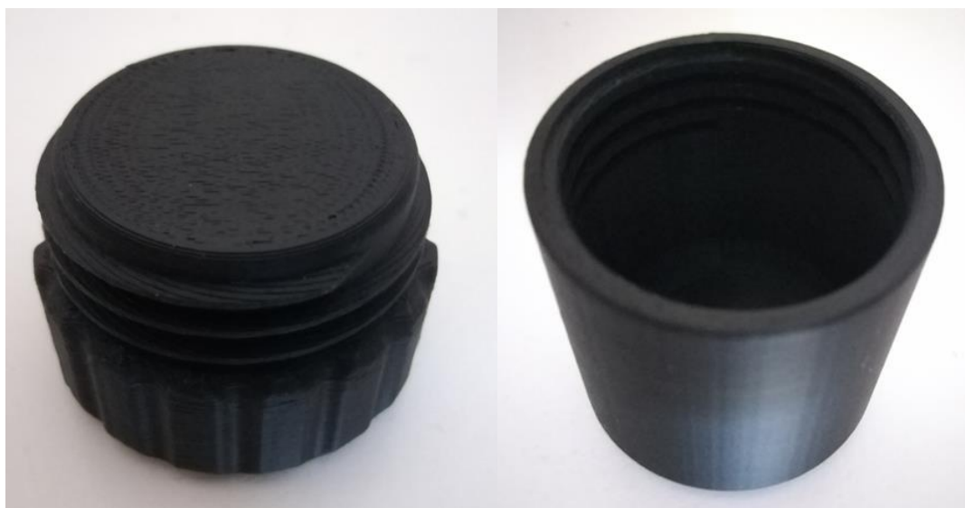
Σχήμα 6.3: Στο σχήμα φαίνονται τα δύο τμήματα που ενώνονται μεταξύ τους. Αριστερά φαίνεται το μοντέλο που διαθέτει το εξωτερικό σπείρωμα ενώ στα δεξιά το μοντέλο με το εσωτερικό σπείρωμα.
