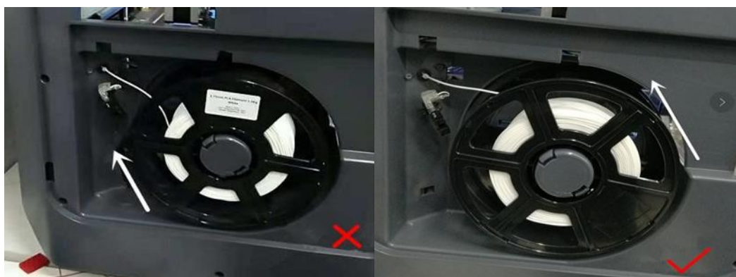
Σχήμα 4.6 :Στα δεξιά φαίνεται η σωστή τοποθέτηση του καρουλιού ενώ στα αριστερά φαίνεται η λανθασμένη τοποθέτηση[10].
