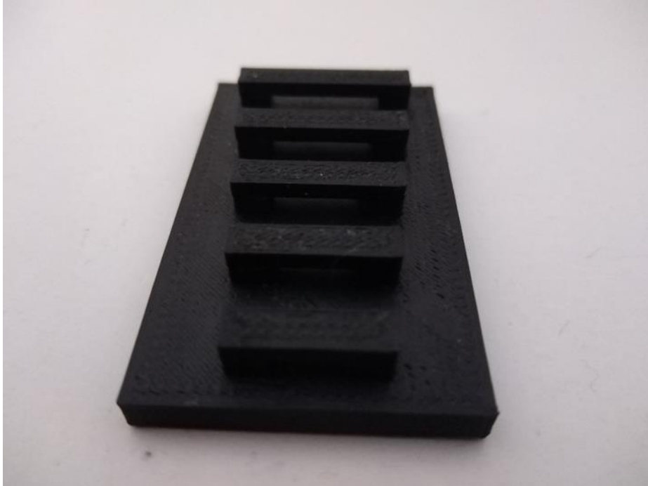
Σχήμα 6.7: Το παραπάνω μοντέλο έχει δομή πλατφόρμας και έτσι παρουσιάζει τα αποτελέσματα πολλών δοκιμών στο ίδιο εκτυπώσιμο μοντέλο.
