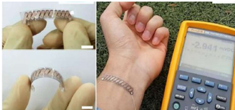
Σχήμα 3. 10 Θερμοηλεκτρικός μετατροπέας σε μορφή επίδεσμο (Kim, Hyung, Jin Cho)[12]
