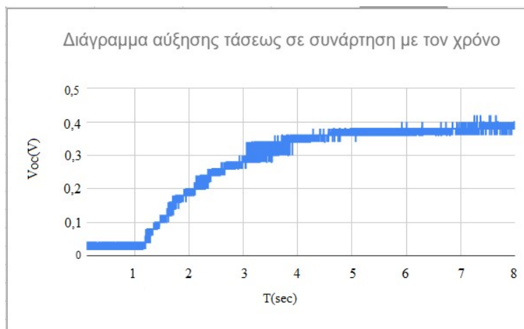
Σχήμα 5.26 Διάγραμμα αύξησης τάσεως ανοικτού κυκλώματος
