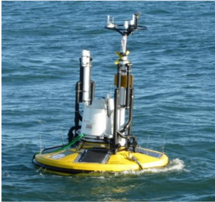
Εικόνα 3.3: Το Wind Lidar Buoy SEAWATCH είναι ένας οικονομικά αποδοτικός τρόπος μέτρησης των δεδομένων ανέμου σε ύψη συμβατικών υπεράκτιων ανεμογεννητριών για αξιολογήσεις αιολικών πόρων και κριτήρια μηχανικού σχεδιασμού.[7](Furgo)
