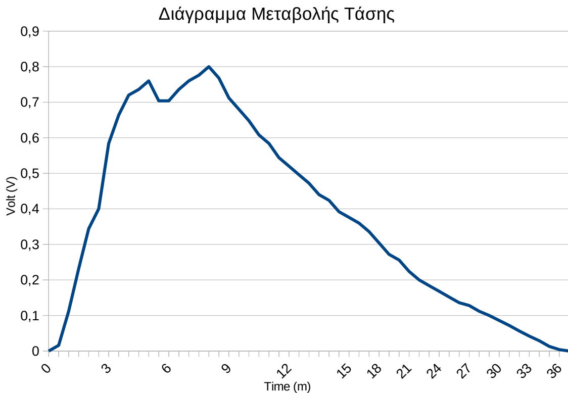
Διάγραμμα 3.9: Διάγραμμα χρόνου-τάσης για φόρτιση πυκνωτή 47 \mu F (κύκλωμα 3.5) ταλαντώνοντας τον αισθητήρα με τη χρήση ηχείου 5W
