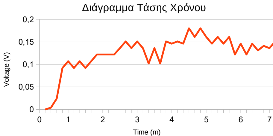
Διάγραμμα 3.1: Διάγραμμα χρόνου-τάσης για φόρτιση πυκνωτή 47\mu F (κύκλωμα 3.1) ταλαντώνοντας τον αισθητήρα με το χέρι
