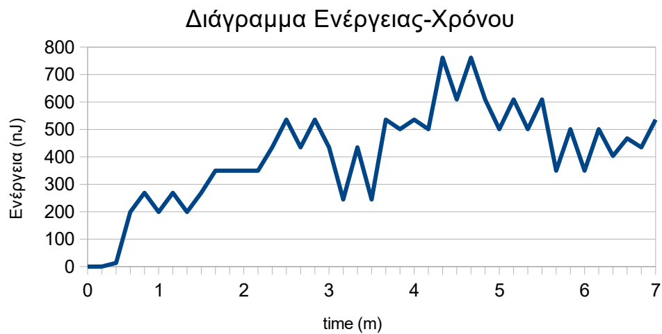
Διάγραμμα 3.2: Διάγραμμα ενέργειας-χρόνου για φόρτιση πυκνωτή 47\mu F (κύκλωμα 3.1) ταλαντώνοντας τον αισθητήρα με το χέρι
