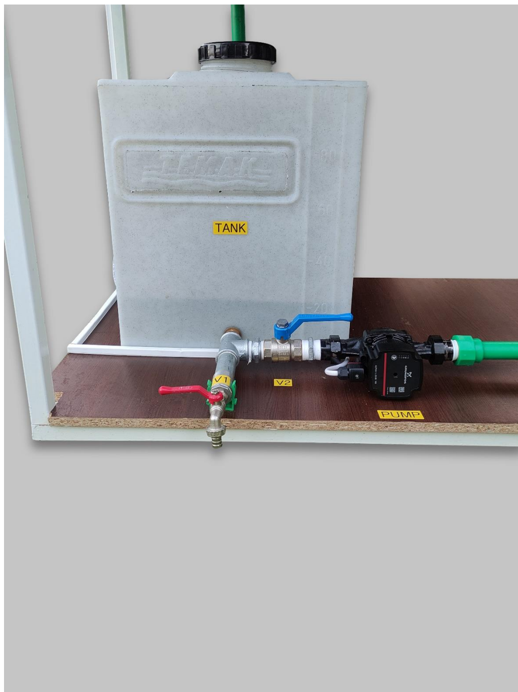
Σχήμα 3.11 Δεξαμενή και κυκλοφορητής
