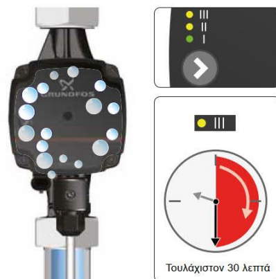
Σχ. 7 Εξαέρωση του κυκλοφορητή
