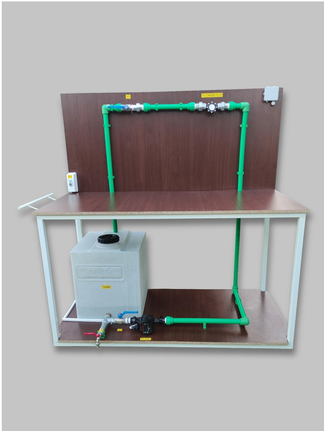
Σχήμα 3.15 Κλειστό σύστημα ροής ρευστών
