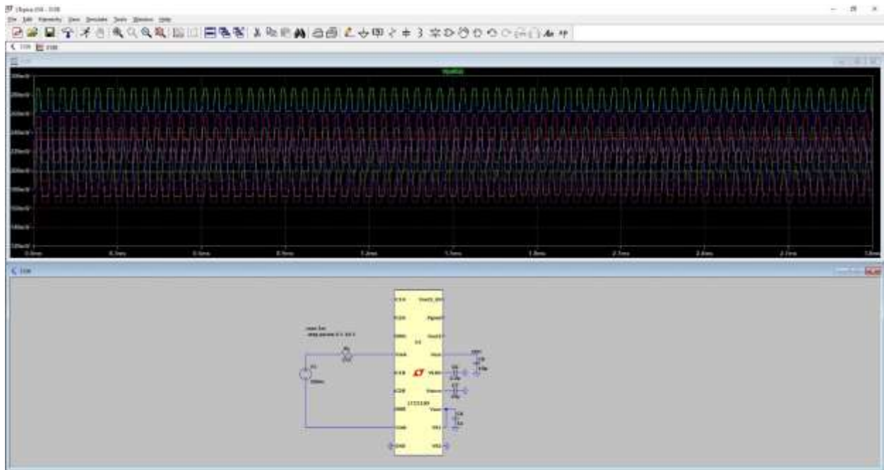
Σχήμα 2.20 Αντίσταση εισόδου στα 500mV από 1Ω έως 10Ω
