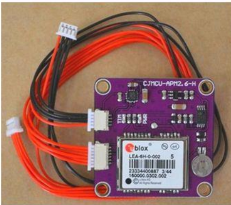
Σχήμα 4.6 Εξωτερικό σύστημα λήψης δεδομένων GPS με ενσωματωμένη ψηφιακή πυξίδα
