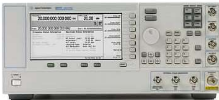
ΕΙΚΟΝΑ 1:ΑΝΑΛΟΓΙΚΗ ΓΕΝΝΗΤΡΙΑ ΣΗΜΑΤΩΝ RF
