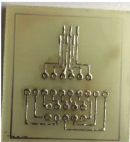
Σχήμα 2.3.19: Η πλακέτα έτοιμη μετά την επικασιτέρωση.
