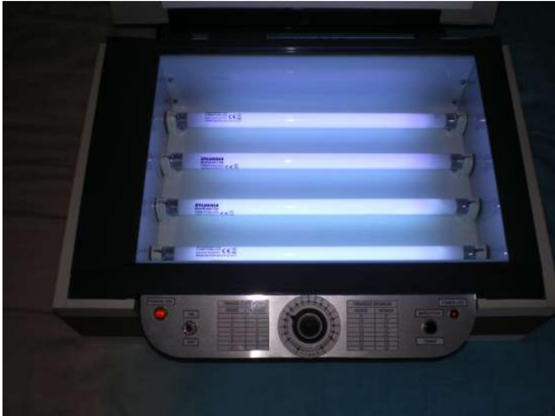
Σχήμα 2.3.3: Θάλαμος τύπωσης κυκλώματος μέσω υπεριώδους ακτινοβολίας
