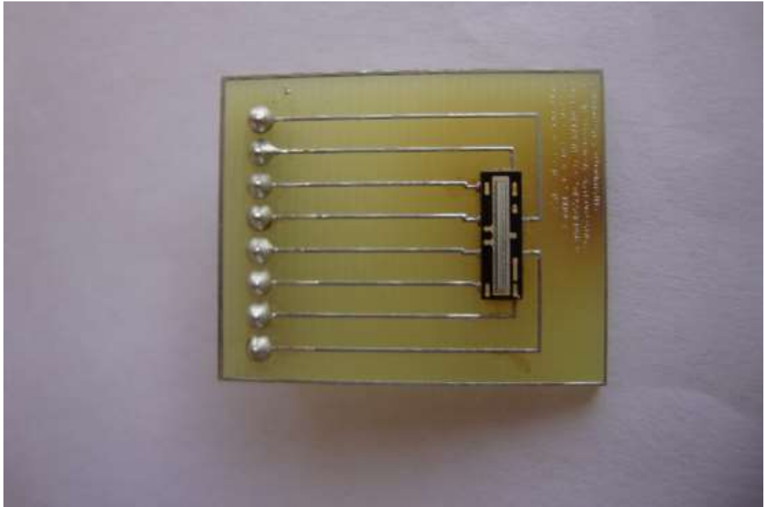
Σχήμα 4.1.2: Φωτογραφία της πλακέτας σύνδεσης του TSL1401CL
