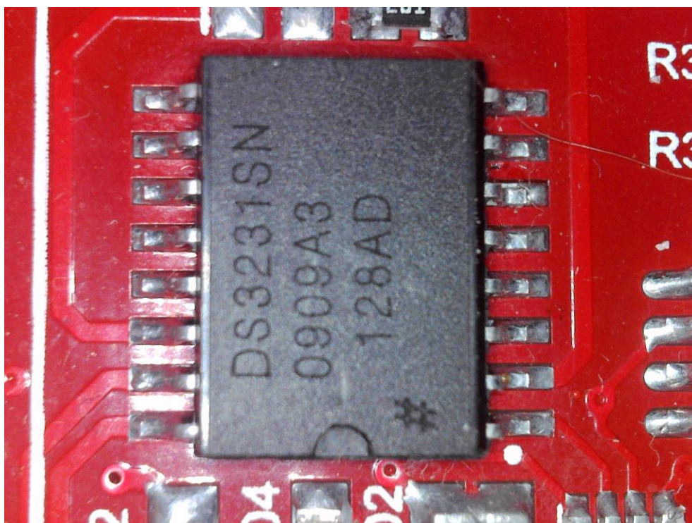
Σχήμα 33: Βέλτιστη κόλληση ως αναφορά (Καθαρίστηκαν τα σφαιρίδια μετά την κόλληση)
