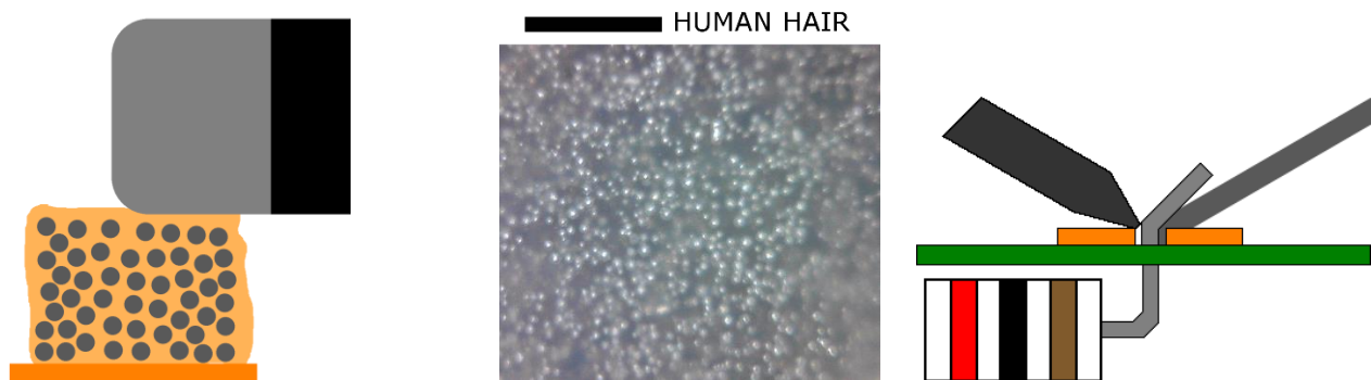
Σχήμα 5: Τοποθέτηση πάστας – Πάστα σε μεγέθυνση – Κόλληση με την χρήση σύρματος.
