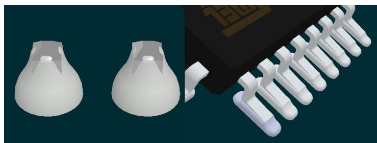
Σχήμα 3: Αριστερά κόλληση THT, Δεξιά κόλληση SMT
