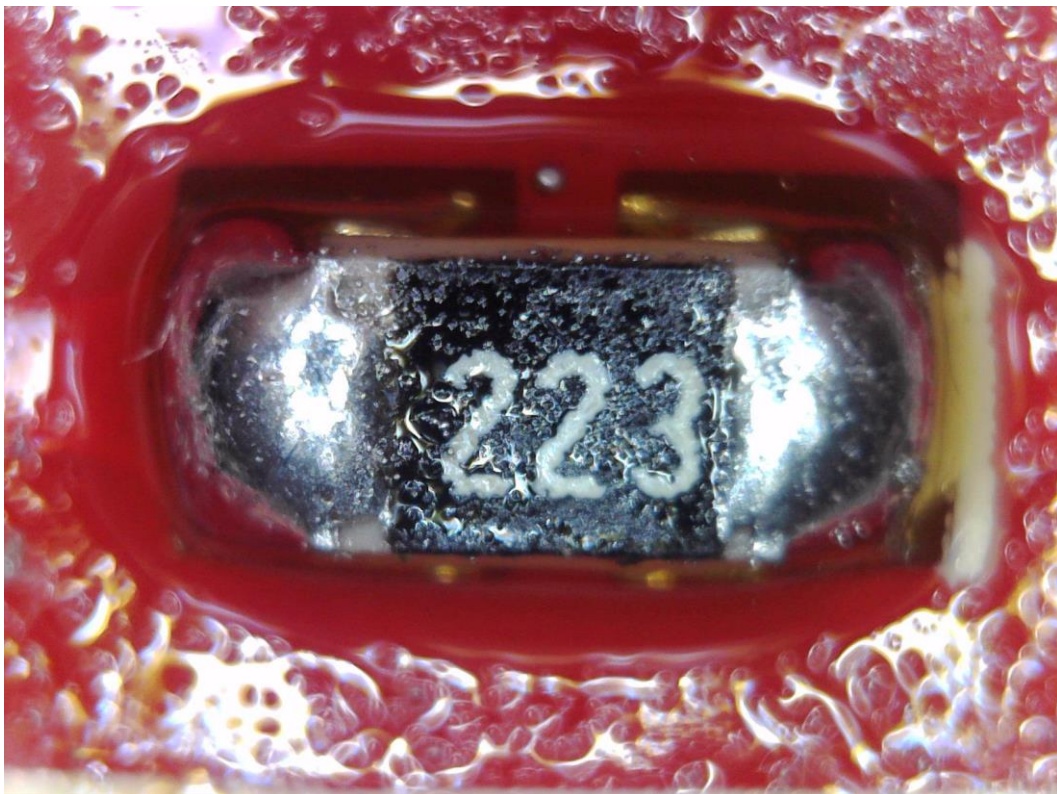
Σχήμα 35: Οριακά αποδεκτή κόλληση, παρατηρούμε λίγα σφαιρίδια.
