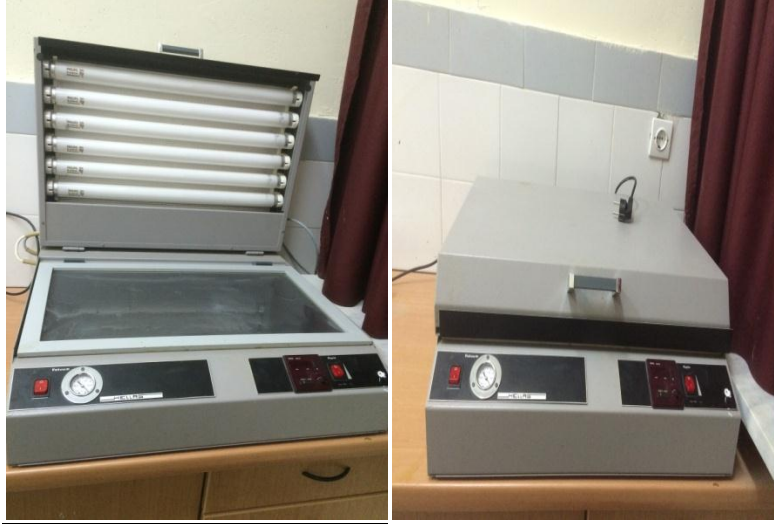
Εικόνα 2.3.3: Τύπωση κυκλώματος στην πλακέτα μέσω υπεριώδης ακτινοβολίας
