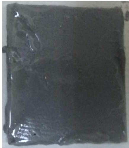
Εικόνα 2.3.9: Η πλακέτα μας επικασσιτερωμένη.
