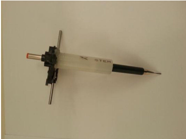
Σχήμα 4.12(εφαρμογή μολυβιού στον οδηγό στο τραπέζι του βηματικού κινητήρα)
