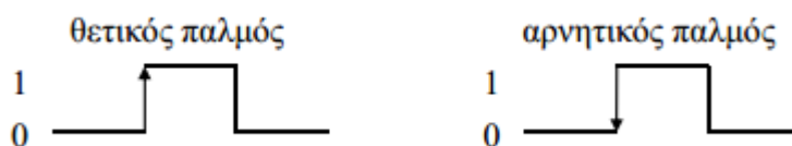
Σχήμα 2.5(σχεδιασμός παλμών Flip-Flop)
