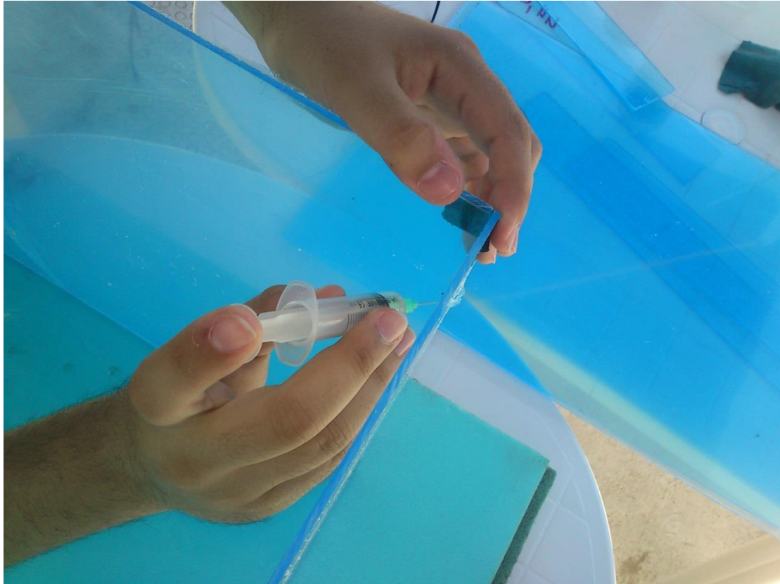
Σχήμα 4.2-Ένωση plexiglas με χρήση χλωροφόρμιου-
