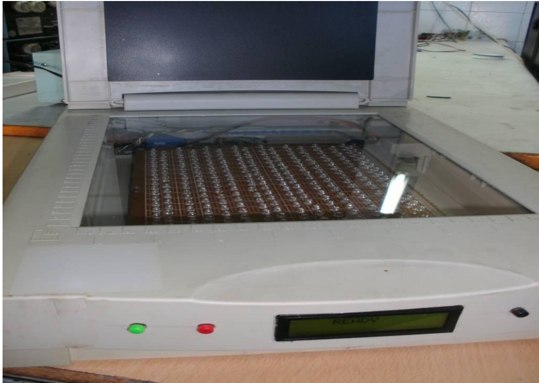
σχήμα 2.9 εκτυπωτής τύπωσης κυκλώματος στην πλακέτα
