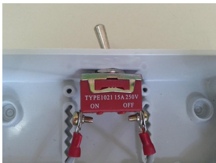
Σχήμα 4.4: Φωτογραφία διακόπτη ON / OFF
