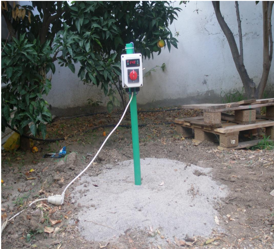
Σχήμα 4.8: Φωτογραφία του συστήματος κατά τη διάρκεια μετρήσεων θερμοκρασίας Άμμου (Ηλιοφάνεια).
